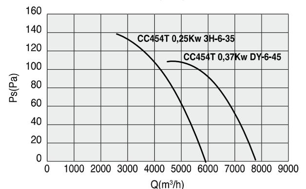
Le prestazioni aerauliche sono rilevate in conformità alla norma EN ISO 5801/AMCA 210 con densità dell'aria standard avente peso specifico 1.2 Kg/m<sup>3</sup>.
