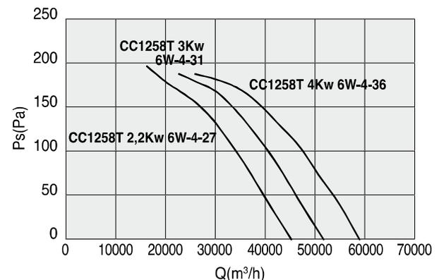
Le prestazioni aerodinamiche sono rilevate in conformità alla norma EN ISO 5801/AMCA 210 con densità dell'aria standard avente peso specifico 1.2 Kg/m<sup>3</sup>.
