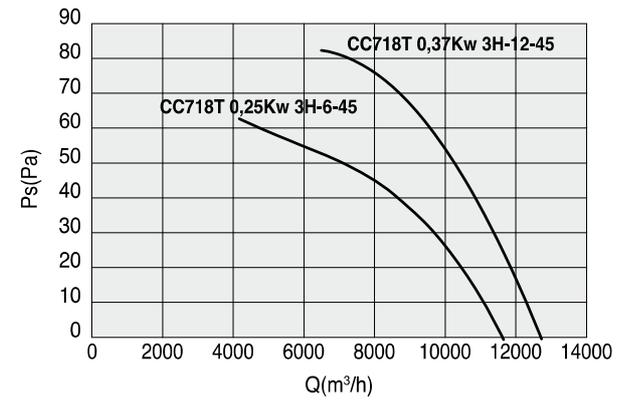
Le prestazioni aeroliche sono rilevate in conformità alla norma EN ISO 5801/AMCA 210 con densità dell'aria standard avente peso specifico 1.2 Kg/m<sup>3</sup>.
