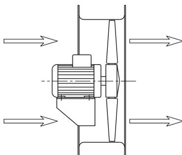
Flusso da MOTORE a GIRANTE (Orientamento standard)
