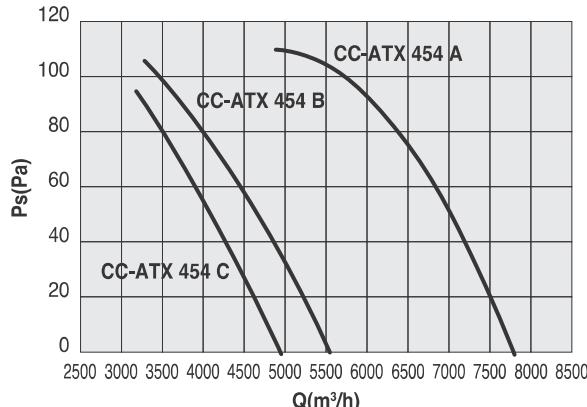
Le prestazioni aerauliche sono rilevate in conformità alla norma EN ISO 5801/AMCA 210 con densità dell'aria standard avendo peso specifico di 1,2 Kg/m<sup>3</sup>.
