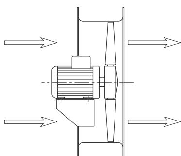
Flusso da MOTORE a GIRANTE (Orientamento standard)
